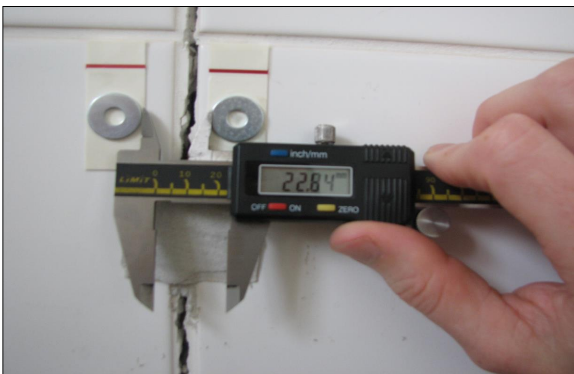
Foto 12. Kompanii 3/5 siseruumides esinevate mõradele paigaldatud majakate mõõtmine.
