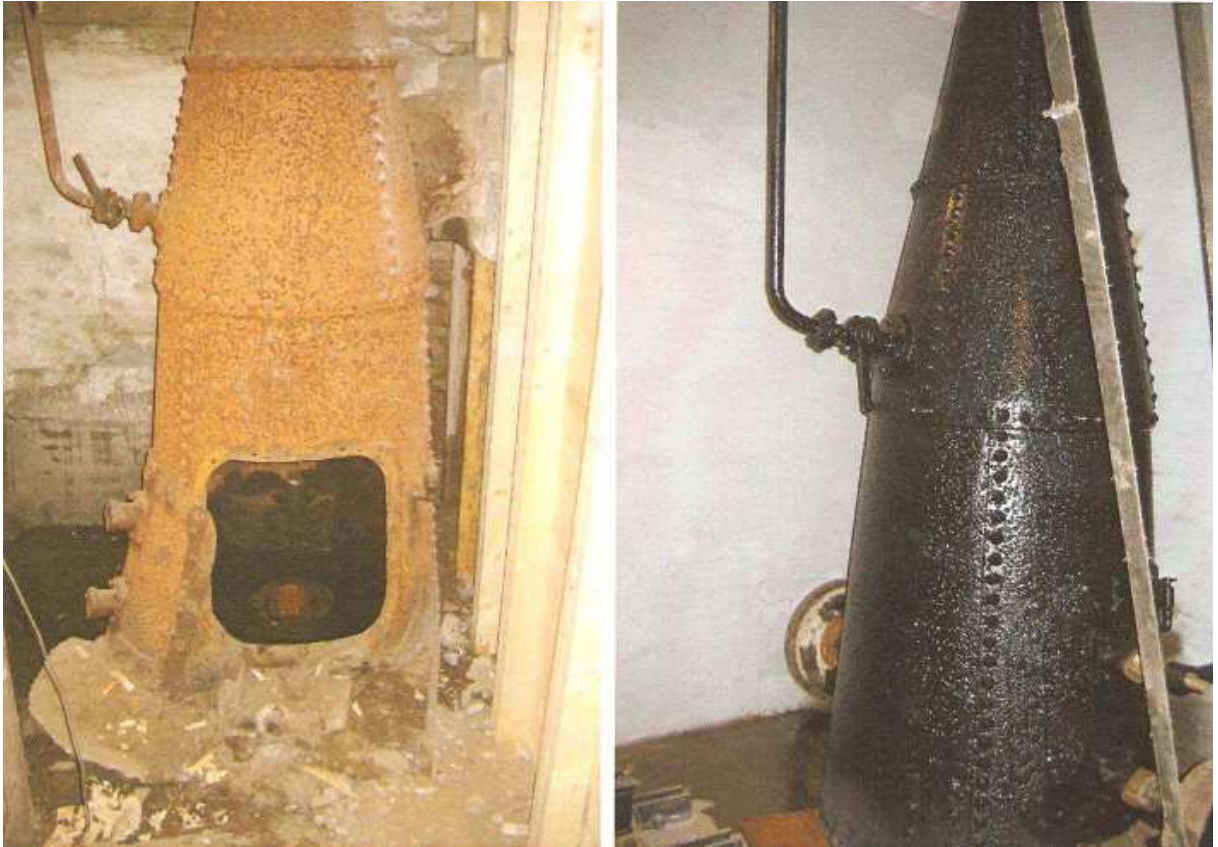
Joonis 20 – turbiin enne ja pärast taastamistööd
