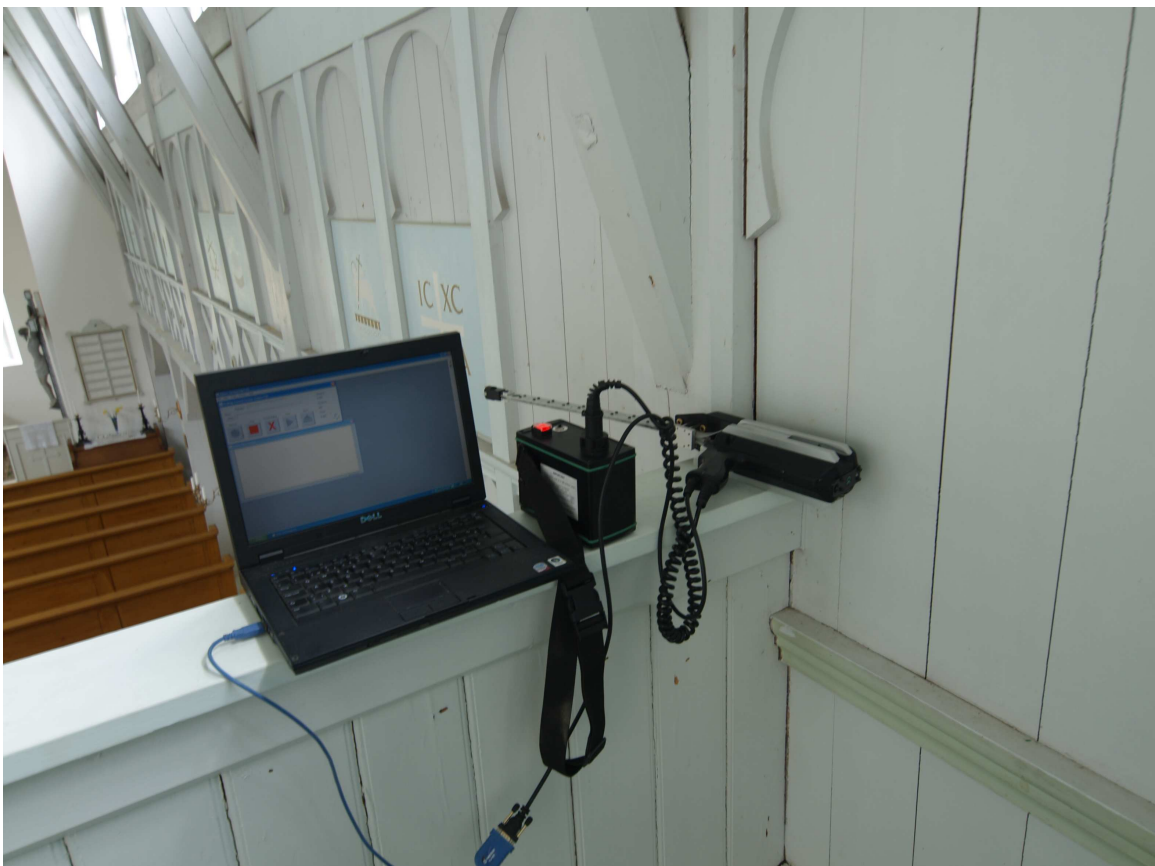
Joonis L7-17. Resistograaf koos ühendatud arvutiga.
