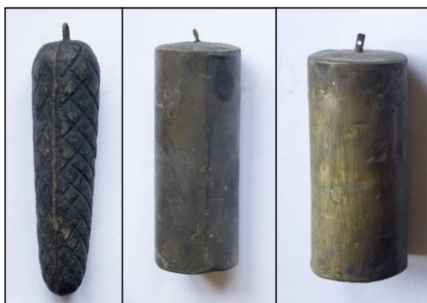
Foto 12. Käbikujuline pomm ning silindrikujulised messinglehega kaetud pommid. Viimased erinevad üksteisest kinnituskonksu poolest.
