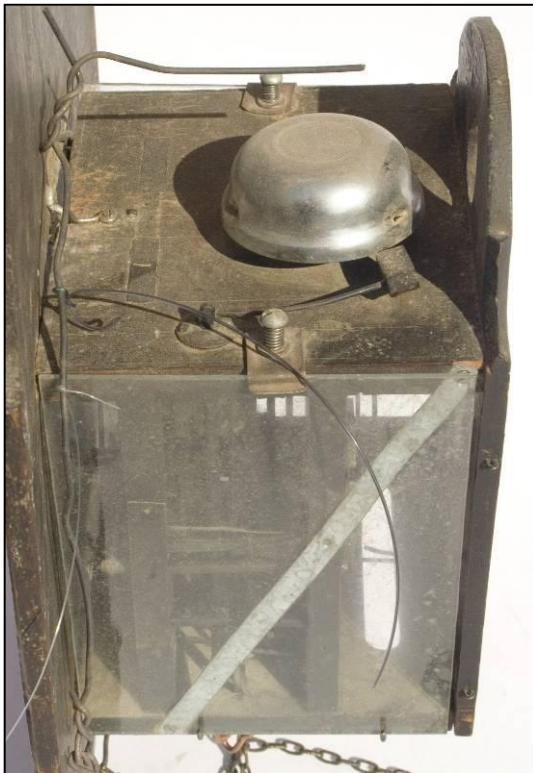
Foto 37. Originaalkelluke on asendatud jalgrattakellukesega, küljeluugid klaasiga
