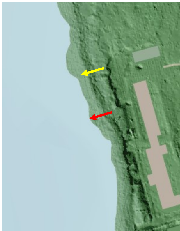
Joonis 17 Reljeefikaardil on näha instituudi asetus rannikul ja kaablikanalid, mis viisid ka lahte.
