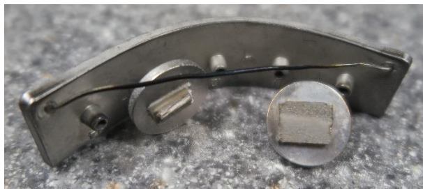
40: Kuld/pallaadiumi kihiga kaetud puiduproovid on valmis SEM uuringuteks.
