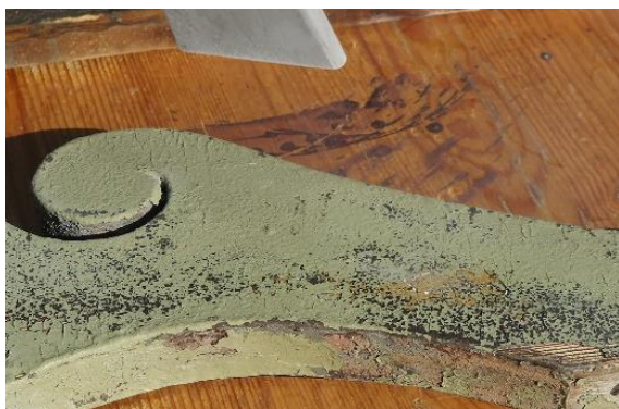
26: Puitpits, lai otsik, rõhk 3 baari. Keskosas on näha kollaka värviga kaetud ala, mille sees eemaldusid kohati kõik värvikihid koos puidutükkidega.
