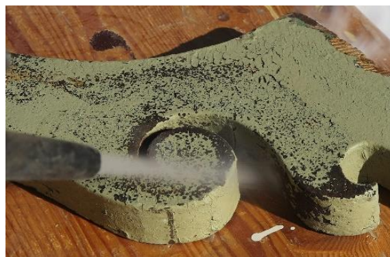
27: Puitpits, toru-otsik, rõhk 3 baari. Valdavalt oli võimalik eemaldada pealmine värvikiht (rohekashall) järgmist (tumepruun) kahjustamata.
