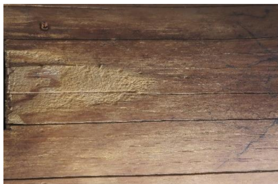
23: Sarikapalk, lai otsik, rõhk 4 baari. Vasakul ovaalne kirvega tahatud ala sai kahjustusi. Seda ümbritsev ümarpalgi pind silmaga nähtavaid kahjustusi ei saanud. Paremalt servas tumedam ala on kuivjääpritsiga töötlemata, millega võrreldes on näha keskmise ala puhastusefekt.
