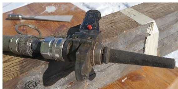
25: Crynomic toru-otsik. Purustussõel on paigaldatud otsiku ja vooliku vahele.
