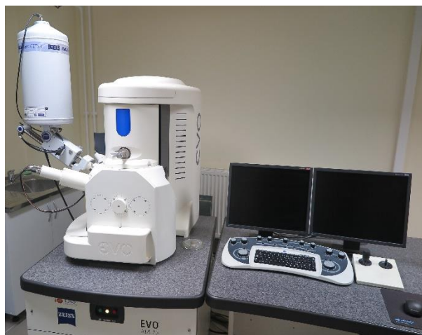
42: Skaneeriv elektronmikroskoop Zeiss EVO MA 15.
