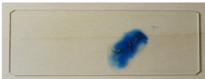
1: Puiduproovilt lõigatud õhukesed laastud värvainega mikroskoobi alusklaasil.
