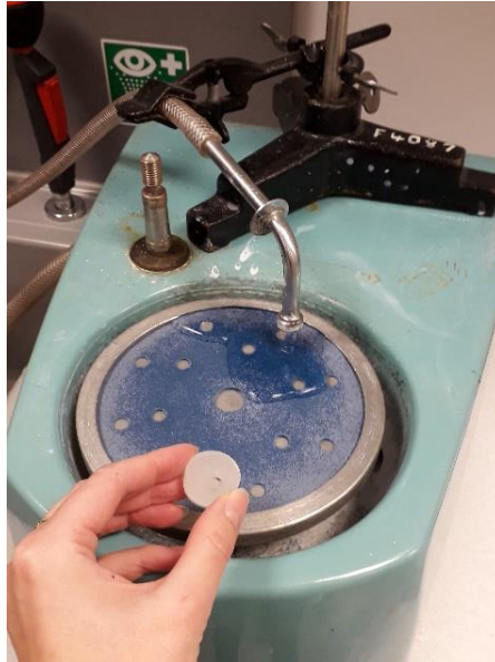
14: Ekstsentrilihvmasinal mikrolihvvi tooriku lihvimine.
