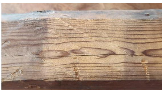
30: Sarikapalk, lai otsik, rõhk 1 baar. Vasakul puhastamata ala, keskel kahekordselt ning paremal ühekordselt töödeldud pind.
