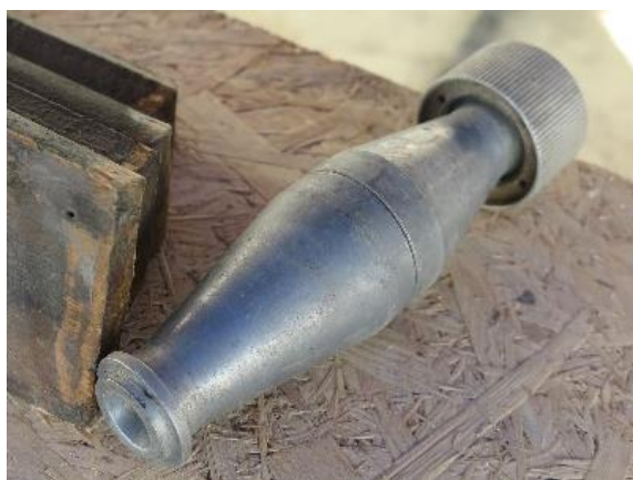
20: Purustussõelaga lisamoodul, mis Intelblast IBL3000 kasutamisel lisatakse otsiku külge.
