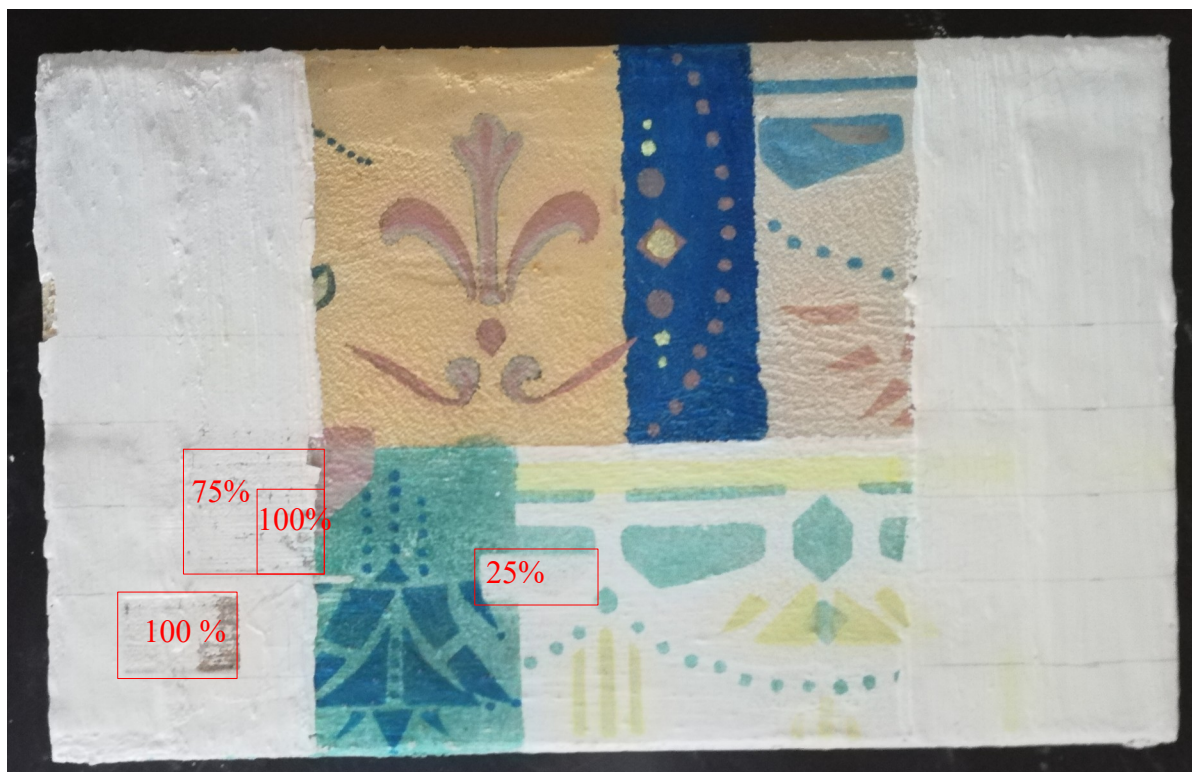
Punaste kastidega on markeeritud puhastusproovide perimeetrid ja kastis olev number tähistab võimsust protsentides. Läätse fookuskaugus 160 mm.
