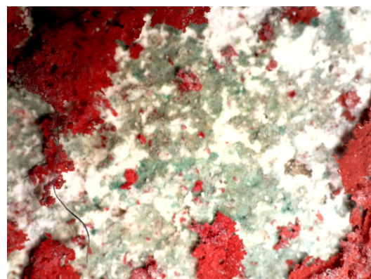
35 - Mudel K pinnal olev punane akrüülvärv laserpuhastuse järgselt.
