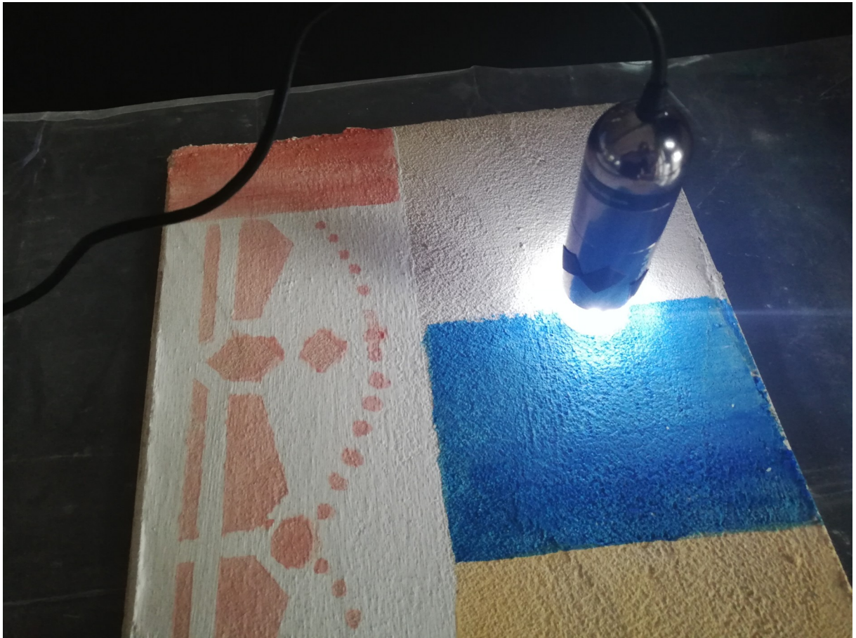
Fotol on kujutatud Dino-Lite mikroskoobiga tehtavad uuringut mudelil E . Uuringuid tehti 50x suurenduse juures.
