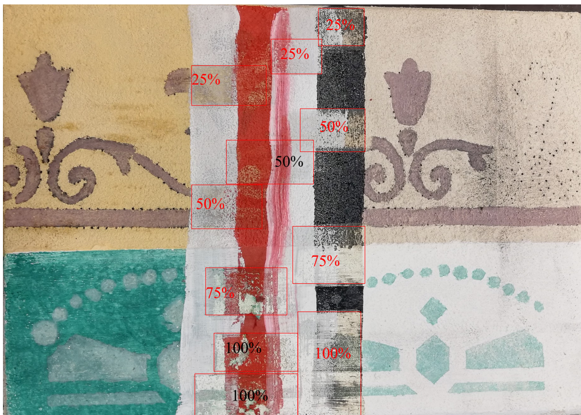
Punaste kastidega on markeeritud puhastusproovide perimeetrid ja kastis olev number tähistab võimsust protsentides. Lätse fookuskaugus 240 mm.
