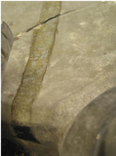
26. Puhastusproov vapikilbi pinnal. Selgelt eristuvad musta pigmendi ja Hõbefooliumiga kaetud pinnad
