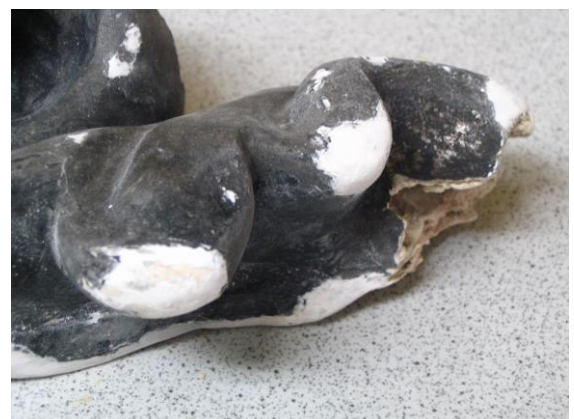
40. Detaili eenduvate osade pinnakahjustused peale kruntimist ja lihvimist
