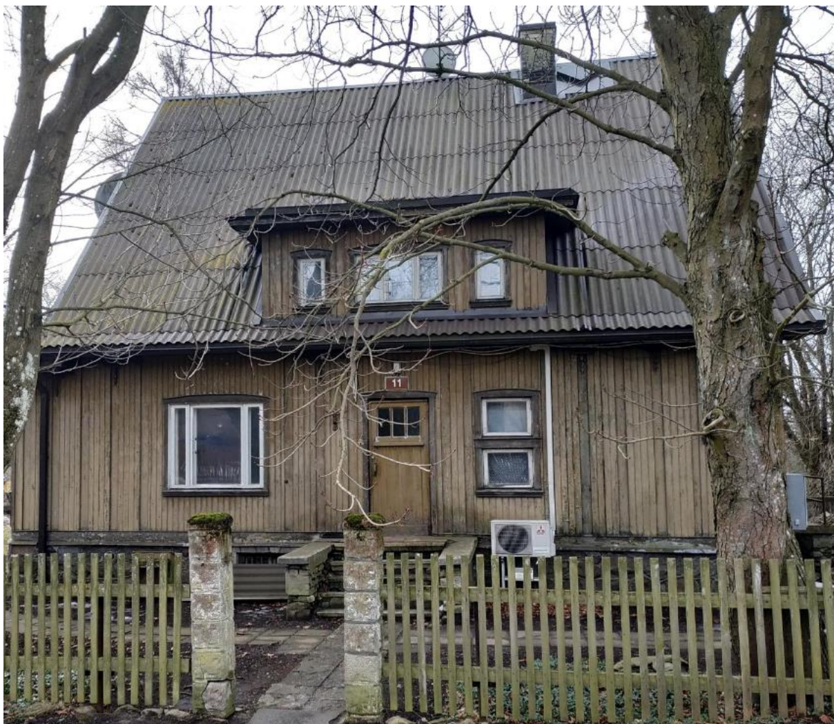
7. Sobimatu paigutusega soojuspumba väline osa. 2019 Aivo Pedak
