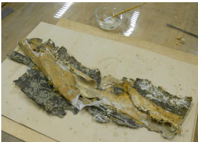
Tapeedikihi (nr. 7) eemaldamine alumiselt tapeedikihilt (mis konserveeritakse)
