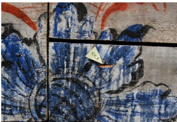
Ill 88 Proov nr 1 (ühest proovitükist teostati 2 mikrolihvi) – sinine
