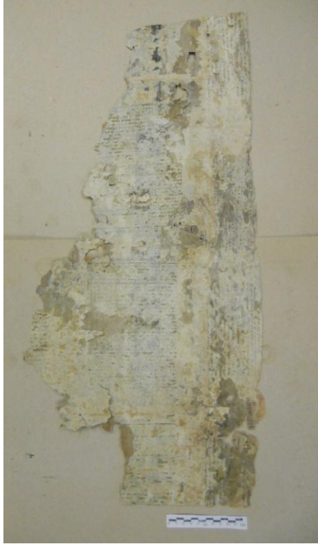
Tapeedikogumi tagakülj pärast värvi-kihtide eemaldamist (kuni makulatuurini)
