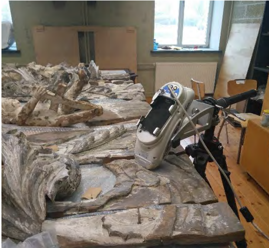
ill 107 p-XRF mõõtmine laua nr 2 siniselt värvilt.
