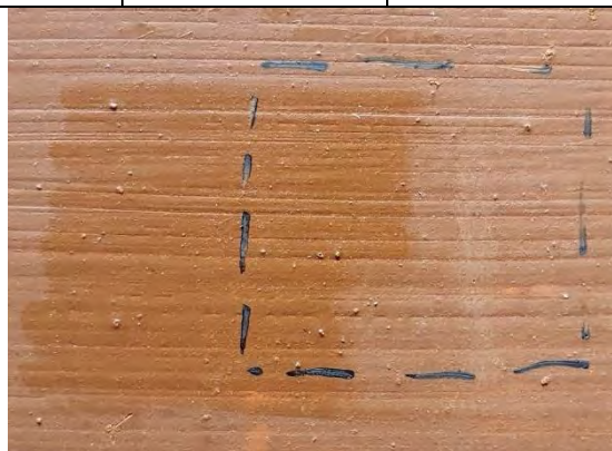
ill 128 MfK kattelaki proov, atsetooniga puhastatud ala.
