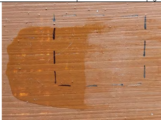
ill 127 Paraloid B-72 kattelaki proov, atsetooniga puhastatud ala.
