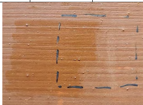
ill 9 MFK kattedihi proov, atsetooniga puhastatud ala.
