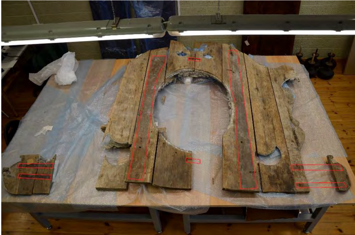
ill 13 Aluslaudade tagusel olevad tumedad toetus prusside ja liistude jäljed ning põõnaavad on markeeritud punaste joontega.
