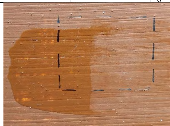
ill 8 Paraloid B-72 kattedihi proov, atsetooniga puhastatud ala.
