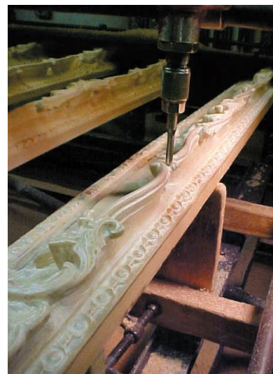
Joonis 11. Vertikaalne puurmasin Masin lõikab korraga 16. toorikust ühesuguse dekooriga raamiliistud.
