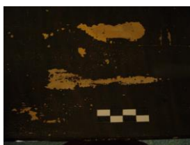
Pildid 1.- 7. detailid niiskuskahjustest.
