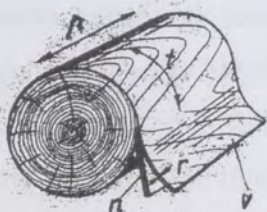
Joon. 81. Hõövelvineeri lõikamine. p — pikiisuund ehk piki kiindu, r — tangentsiaalsuund, r — radiaalsuund, s — nuga, v — vineer.
