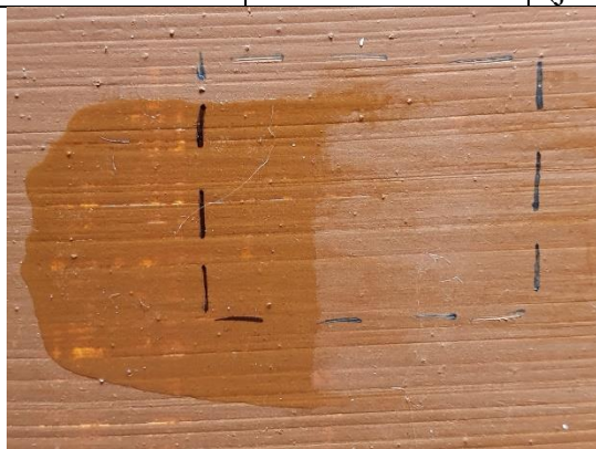
ill 8 Paraloid B-72 kattekihi proov, atsetooniga puhastatud ala.
