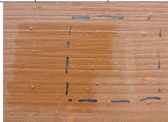
ill 9 MFK kattekihi proov, atsetooniga puhastatud ala.
