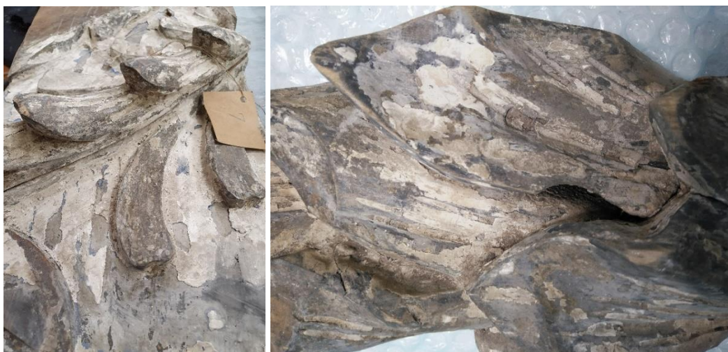
ill 36 Aluslaud nr 7 ja detail nr 10/2, loorberilehestik. Valge värvi alt on paljastunud tume ja helehall kruntvärv. Selliseid värvikadusid krundini esineb kõikidel detailidel.
