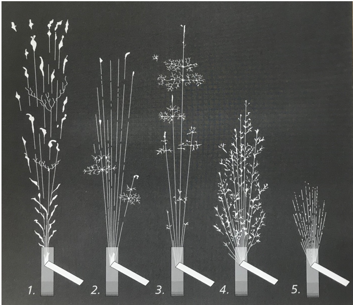
46. Sädemettest: 1)Pudeldatud teras 2)Teras 3)Teras, mille süsinikusisaldus on alla 1% 4)Kiirlõiketeras 5)Malm.
