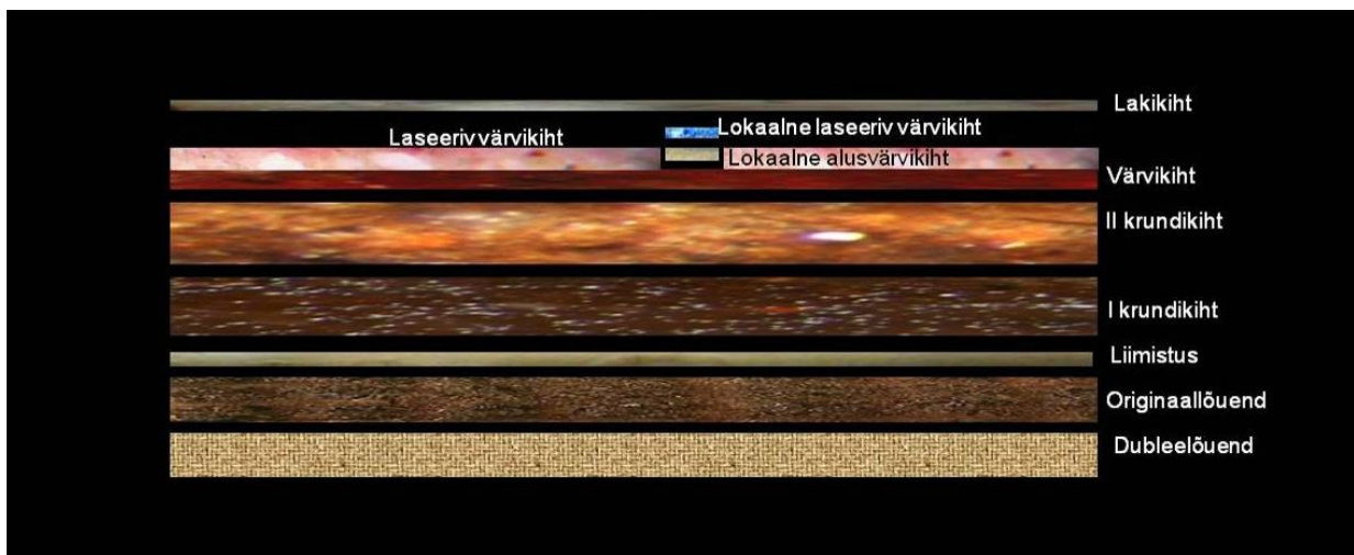
III. 20. Uurimistulemuste põhjal koostatud “Simson ja Deliila” maalitehnilise ülesehituse skeem.
