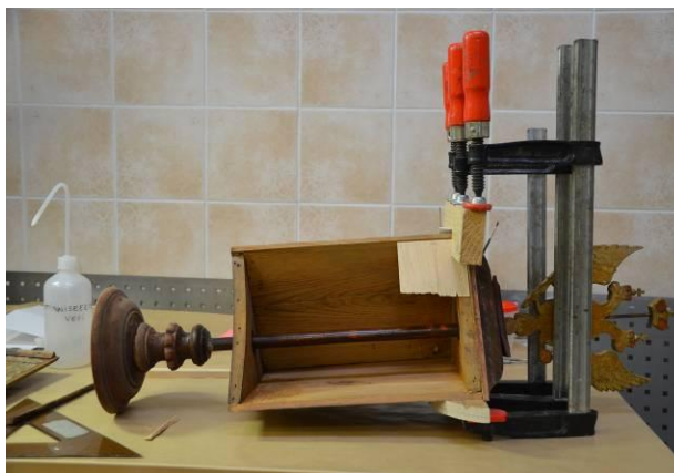
Foto 27. Karkassi uuesti liimitud servadel lasti pitskruidude all kuivada ööpäev
