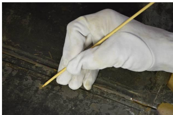
Foto 19. Lahtise rooste eemaldamine plekisti karkassilt Foto: Karl-Erik Hiiemaa (ERM)
