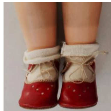
Joonis 5.20: PPVC-sse imbunud mustus. (TMMM 8691, autori foto)
