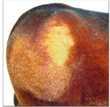
Joonis 5.18: Karvkatte kulumine vahtkummilt. (TMMM 9188, autori foto)
