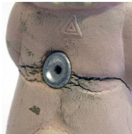
Joonis 5.8: Oksüdatsiooni tagajärjel kõvaks ja hapraks muutunud vulkaniseeritud kummi. Kuna metall on kummist kõvem, on esemesse tekkinud lõhed. (TMMM 4945, autori foto)
