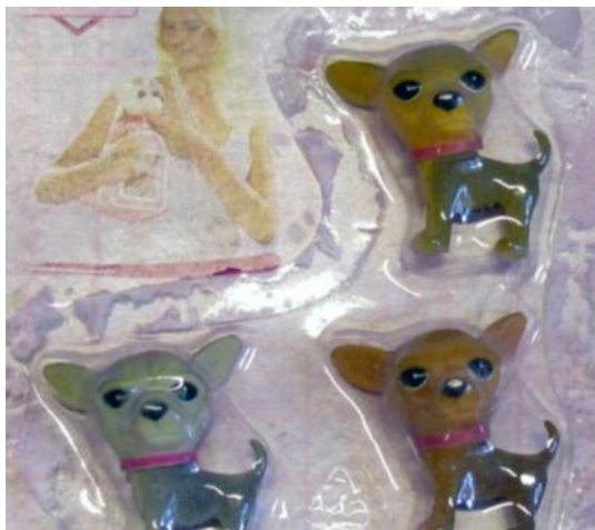
Joonis 2.3: PET-st valmistatud pakend on läbipaistev. Seevastu PVC-st koerad on tuunjad, mis on lisatud täideainete tõttu. (Autori foto)
