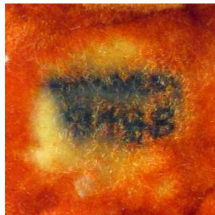
Joonis 5.13: Sobimatu kirjutusvahendi kasutamisest tekkinud kahjustus vahtkummist mänguasjal. (Autori foto)
