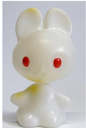
Joonis 5.4: Survevaluvormimisel toodetud mängujänesel on näha vormi äärtesse tekkinud põletusjälgi. (TMMM 10512, autori foto)
