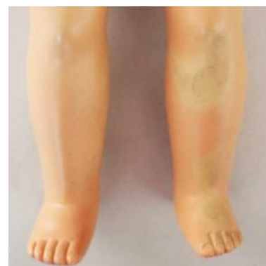
Joonis 5.21: Hõõrdumiskahjustus. (TMMM 7932, autori foto)
