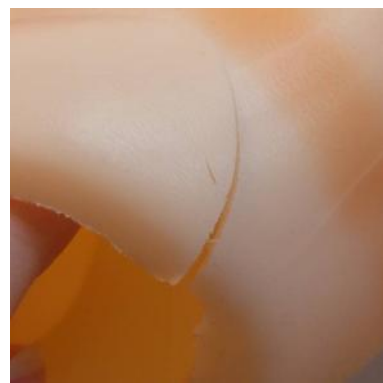
Joonis 5.22: Lõhenenud HDPE. (Autori foto)
