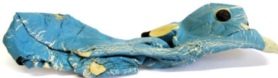
Joonis 5.17: Tugeva termokahjustusega vulkaniseeritud kummist orav. (TMMM 2701, autori foto)
