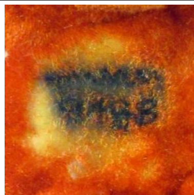
Joonis 5.36: Lahustikahjustus PPVC-l. (TMMM 9168, autori foto)
