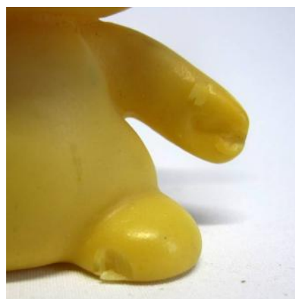
Joonis 5.7: Valguskahjustus PPVC-st valmistatud mänguasjal. (TMMM 2707, autori foto)
