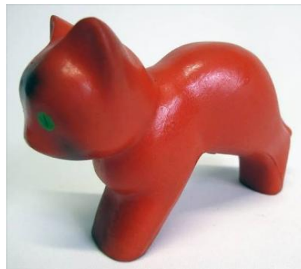
Joonis 5.15: PPVC pinnale migreerunud DEHP. (TMMM 7004, autori foto)
