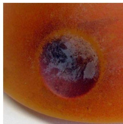
Joonis 5.12: PPVC-st eraldunud steariinhape. (Autori foto)
