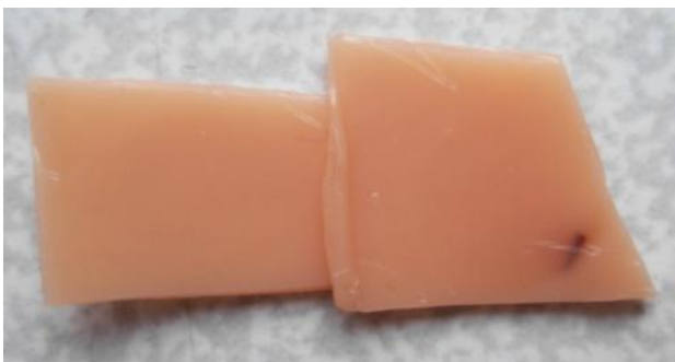
Joonis 9 – Kuumakeevitusega loodud ühendus proovitiikidel.
