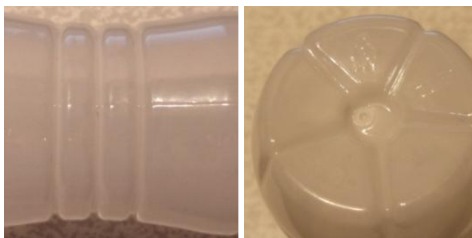
Joonis: 4.6 ja Joonis: 4.7: Puhumismeetodil valmistatud pudel. (Autori fotod)
