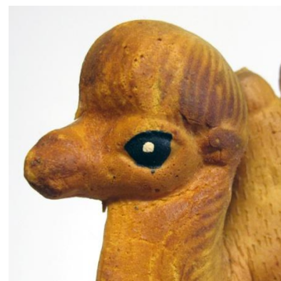
Joonis 5.9: Oksüdatsiooni tulemusel kollaseks ja rabedaks muutunud vahtkumm. (TMMM 5932, autori foto)
