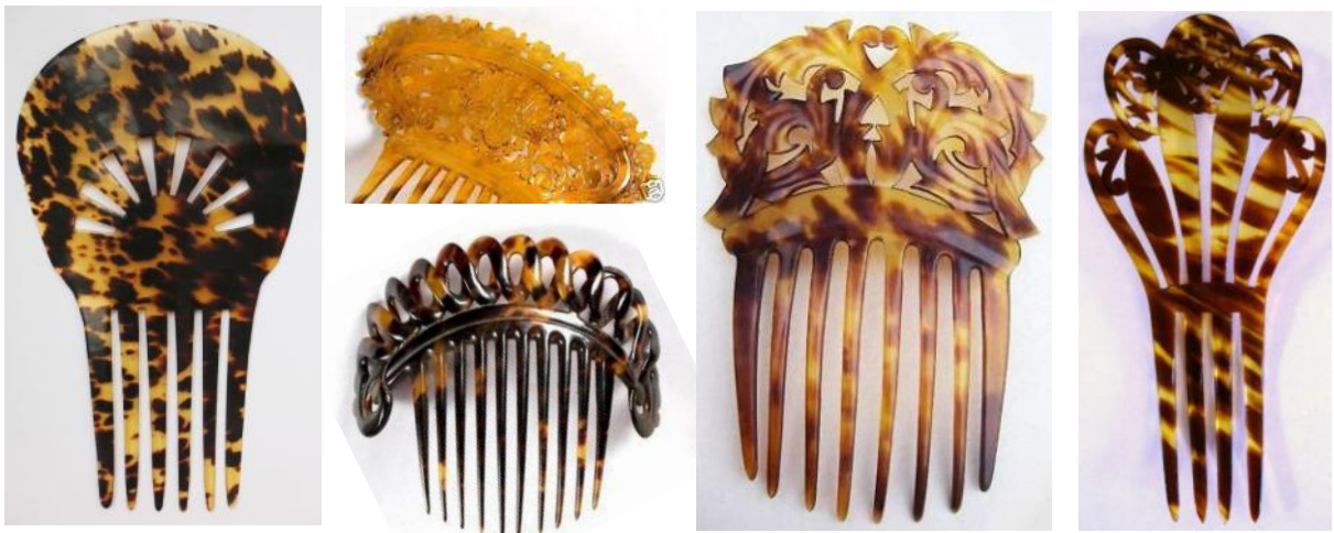
Joonis 4.4: Kilpkonnaluu ja selle imitatsioonid. Vasakpoolsed kolm kammi on kõik kilpkonnaluuust valmistatud. Paremtal teine on toodetud sarvest ning esimene nitrotselluloosist.
