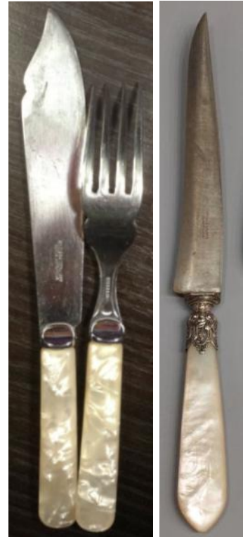
Joonis 4.1: CA-st võltspärlmutter võib tõelisele materjalile väga sarnane olla. Vasemal on tehiskäsi ja paremal ehe materjal.
