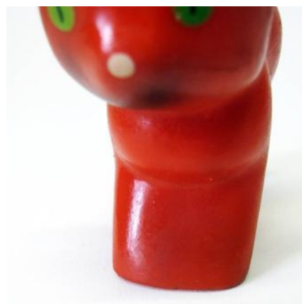
Joonis 5.11: Eraldunud DEHP on PPVC-st mänguasja kleepuvaks muutnud. (Autori foto)
