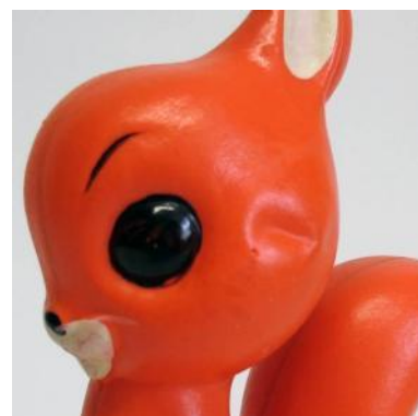
Joonis 5.23: Kahjustunud tselluloid. (TMMM 5022, autori foto)
