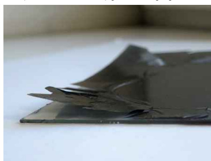
120./121./122. Liimi- ja paberijäägid emulsioonil (vasakul), emulsiooni irdumine (keskel, paremal), EFA f 215
