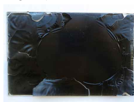
120./121./122. Liimi- ja paberijäägid emulsioonil (vasakul), emulsiooni irdumine (keskel, paremal), EFA f 215
