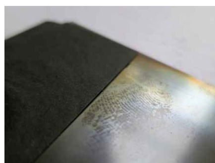
117./118./119. Purunenud klaas (vasakul, keskel) ja sõrmejäljed emulsioonil (paremal), EFA f 215
