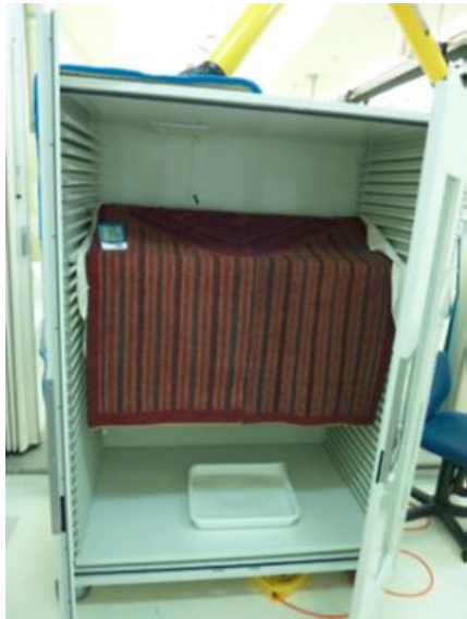
39, 40. Tekstiilide kuivatuskapist ümber ehitatud niisutus- ja tuulutuskamber. Kamber sobib hästi naftaleeni-, pDCB ning teiste niiskusega eralduvate biotsiidijääkide eemaldamiseks tekstiilidelt.
