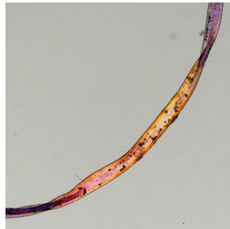
29. Polariseeriva valgusega mikroskoobis vaadeldud villane kiud 100x suurendusel. Kiuproov pärineb kahjustunud piirkonnast, hästi on näha värvaine pleekimine villakiust.
