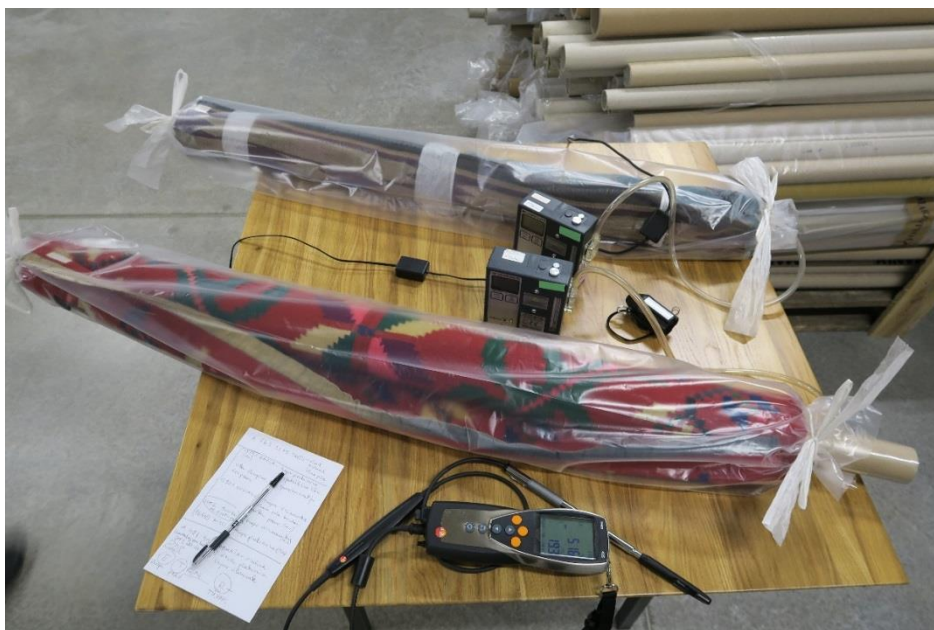
37. Terviseameti Tartu labori õhuanalüüside kogumise protsess. Õhu pumpamine vaiba pakenditest 8 h jooksul. Kogutud proovile tehti laboris keemiline analüüs, mis tuvastas vaiba pakendites \alpha -pineeni sisalduse.
