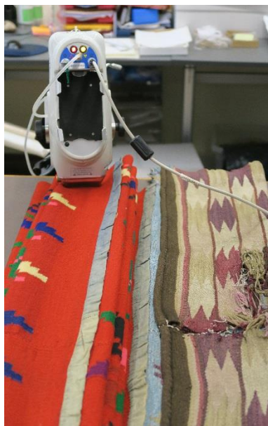
35, 36. Portatiivse röntgen-fluorestsents-spektromeetrilise (pXRF) uuringu eesmärgiks oli tuvastada tervisele ohtlike metallide, nagu arseen ja elavhõbe, võimalik sisaldus uuritavates vaipades.
