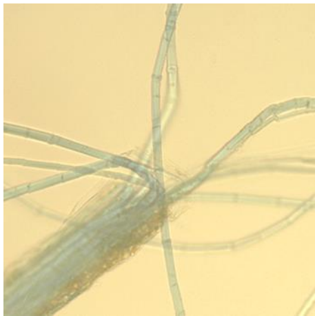
28. Polariseeriva valgusega stereomikroskoobis 100x suurendusega linane kiud. Pildil on näha ühtlaselt säilinud sinine värvitoon ja linasele kiule iseloomulikud sõlmed ning risti asetsevad sälgud.
