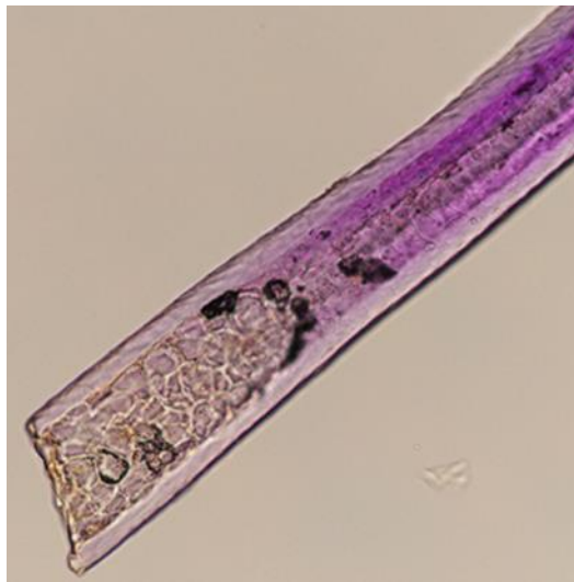
22. Pildil on näha kiu säsikanalit, aga pinnal ka villale väga iseloomulikku soomusjat kihti. Need on villakarvale iseloomulikud jooned ning aitavad villa eristada siidist ja tsellulooskiududest.
