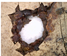
18. Korrodeerunud naelaauk, Dino-Lite digitaalmikroskoop, suurendus 20x.
