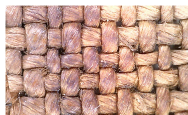
17. Lõuendi struktuur, Dino-Lite digitaalmikroskoop, suurendus 20x.
