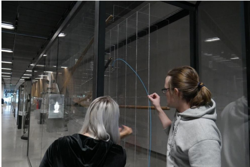
6. Kiirendusanduri paigaldamine relvavitriini ülemisele pleksiklaasist osale.
