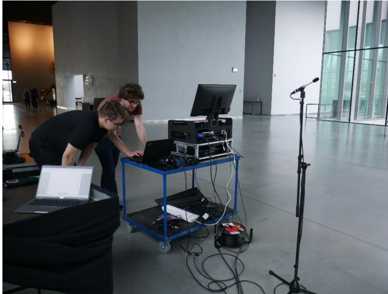
12. Mõõtemikrofoni seadistamine ERMi silla-alal.
