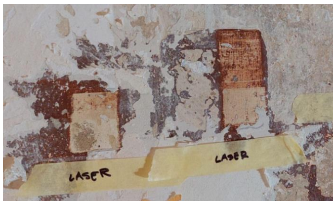
59. Värvide eemaldamise katsete tulemused laseriga. Foto K. Klaamas.
