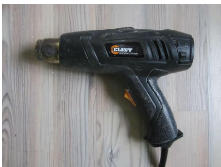
26. Kuumaõhupuhur Clint, CL-HG2000, 2000W. Puhur on kahe režiimiga - temperatuur 350°C või 600°C, õhu hulk vastavalt 300 l/min või 500 l/min.
