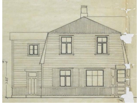
III 25. Punasest joonest üleval pool olev laiem (vana) fassaadilaudis. Puudub esimesel korrusel vertikaallaudis. Kõrval joonise väljavõte (1947 a)
